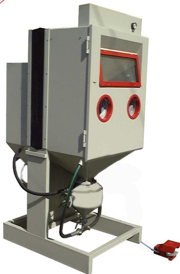
Sabbiatrice a cabina manuale dotata di serbatoio a pressione e sistema automatico di recupero del materiale abrasivo utilizzato, filtrazione e separazione polvere.
